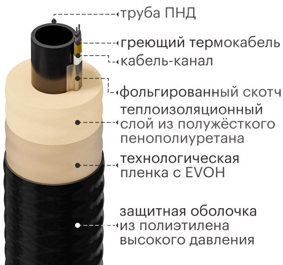
Рис.1. Конструкция трубы ТВЭЛ-ПЭКС-ХВС
