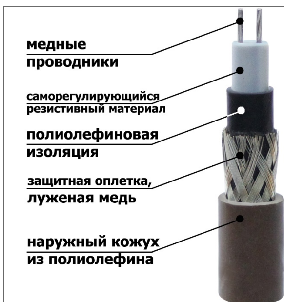
Рис. 25. Конструкция саморегулирующегося термокабеля
